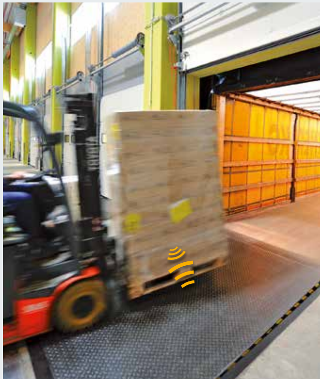
Automatické zachycování pohybů zboží, jednoduše při přejezdění nakládacího můstku.
