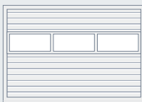
Motiv 480 Lamelová výplň s hliníkovým rámem vyplněným roztahovací mříží Ventilační průřez: 58 % plochy výplně na rám
