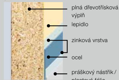
Plná dřevotřísková výplň (volitelně) pro lepší ochranu proti hluku
