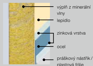
Výplň z minerální vlny (volitelně) pro lepší tepelnou izolaci
