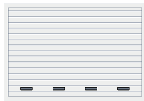
Motiv 480, lamelová výplň s větracími mřížemi Ventilační průřez: 40 cm 2 /mříž
