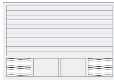
Motiv 499 , příklad s výplní s lamelami, perforovaným a hliníkovým plechem
